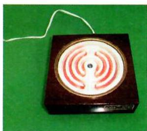
La energía eléctrica se transforma en energía calorífica. El color rojo en la cocina demuestra la alta temperatura en la resistencia.
