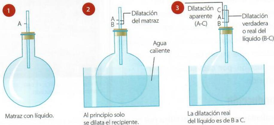
Los líquidos tienen mayores coeficientes de dilatación que los sólidos, aunque no son constantes: varían con la temperatura. El mercurio es el líquido con coeficiente de dilatación más constante; por eso se utilizó para fabricar termómetros.
