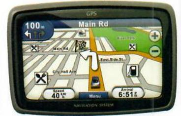
**Sistema de Posicionamiento Global - GPS.** Un GPS (*Global Positioning System*) es un sistema de operaciones formado por satélites de navegación y satélites de control de órbita. El receptor GPS convierte la señal codificada que envía el satélite en valores de velocidad, posición y tiempo.
