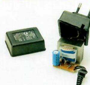
Muchos aparatos electrónicos utilizan un transformador para funcionar, puesto que necesitan una alimentación de unos pocos voltios (5; 9; 12...).
