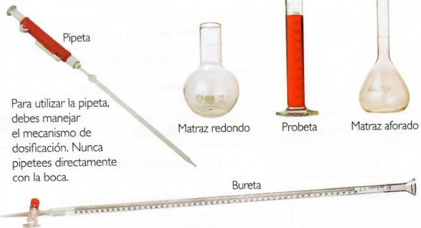
Para utilizar la pipeta, debes manejar el mecanismo de dosificación. Nunca pipetees directamente con la boca.
