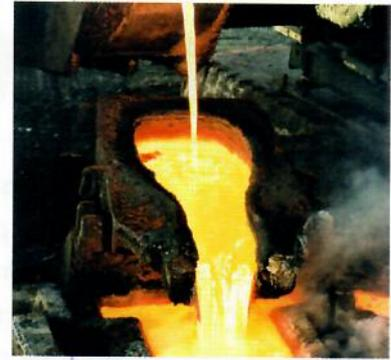
En los altos hornos y en las fraguas, se calienta el metal para darle forma. Lo que está ocurriendo es una transferencia de energía térmica desde el horno hasta el metal. Esta energía térmica es capaz de alterar la estructura interna del metal, lo que modifica sus propiedades (su capacidad para ser moldeado, por ejemplo).
