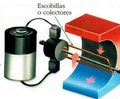
Un motor de corriente continua transforma energía eléctrica a mecánica.
