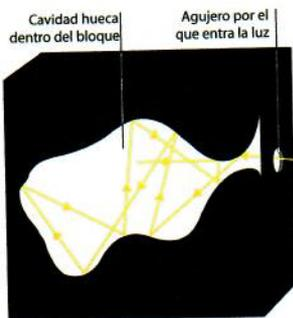
Un cuerpo negro es aquel que solo emite la radiación debida a su estado térmico; cualquier otra radiación que llegue a ese cuerpo es absorbida por él. Una buena aproximación es un objeto hueco con un orificio, de forma que cualquier radiación que penetre desde el exterior sufra reflexiones que solo la lleven de nuevo hacia el interior o sean absorbidas.
