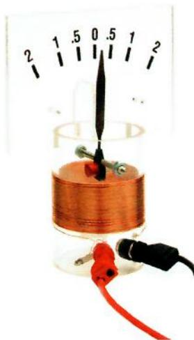
Un galvanómetro es un aparato de medida en el que la corriente que se va a medir pasa por una bobina (conjunto de espiras) suspendida entre los polos de un imán.
