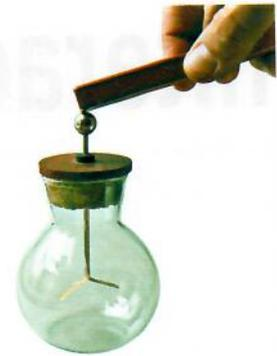
El **electroscopio** está formado por dos hojas metálicas colocadas en el extremo de una barra metálica y protegidas por un frasco. Al cargarse con cargas del mismo tipo, las dos hojas se repelen.
