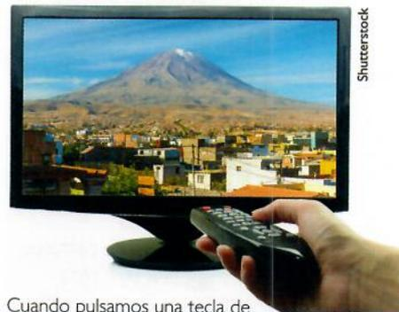
Cuando pulsamos una tecla de un control remoto, este emite radiación electromagnética (infrarroja) que llega hasta el detector de un televisor o un equipo de música, por ejemplo, y provoca en este un cambio: aumento o disminución del volumen, variación del brillo de la imagen, etc.
