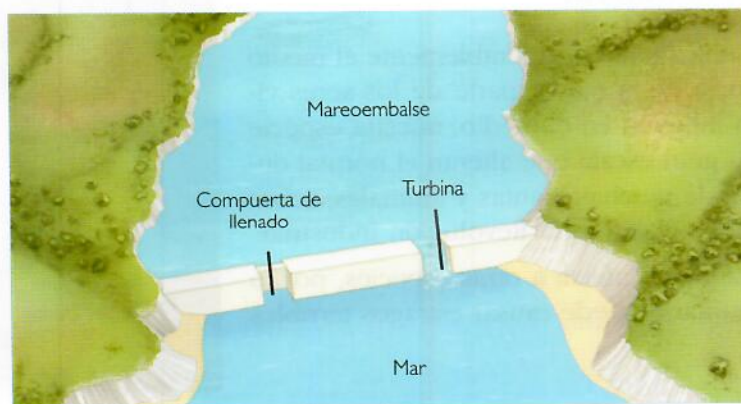
Esquema de una central de energía maremotriz
